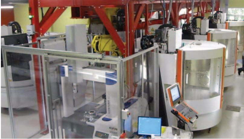
Cellule robotisée multi CNC, équipement de polissage et CMM
