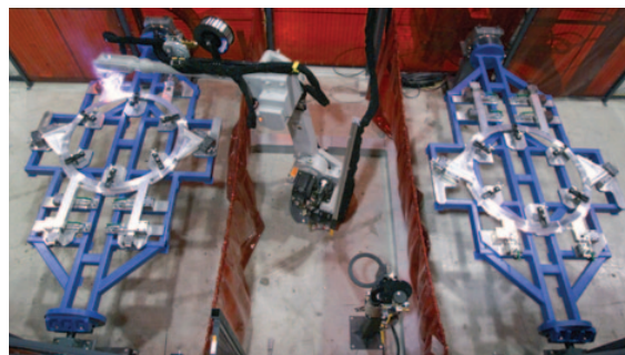
Cellules de soudure multi-gabarits permettant de maximiser le temps du robot soudeur
