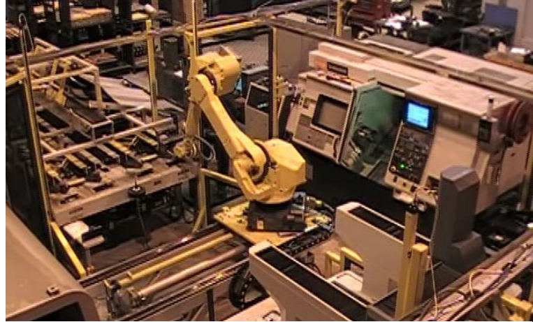
Cellule robotisée multi CNC, équipement d'ébavurage et CMM
