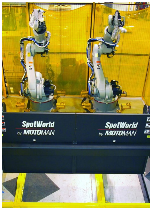
Cellules de soudure multi-robots
