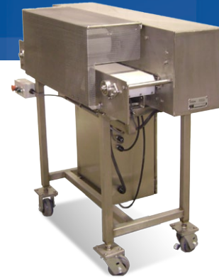
Conditionneurs permettant d'uniformiser et d'attendrir la viande
